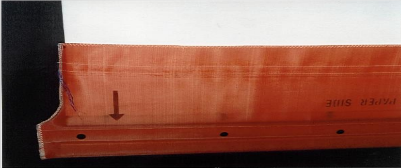
1 - Vue du feutre non emballé avec tablier « leader » rectangulaire.
